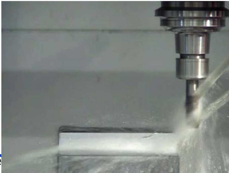
加工時の「びびり」(振動)を検出
